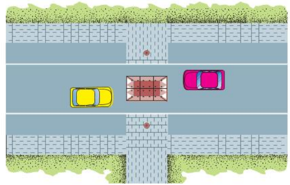
Plateau-Aufpflasterung im Streckenbereich; Straßenbreite mind. 3,30 m.
