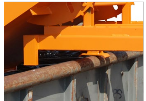
② Manuelle Entriegelung durch Zugseil
