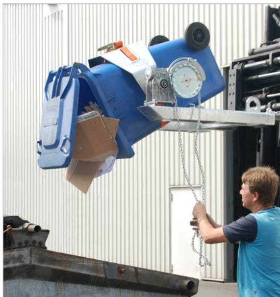
FLEX-K, Entleerung 240-l-Müllbehälter
