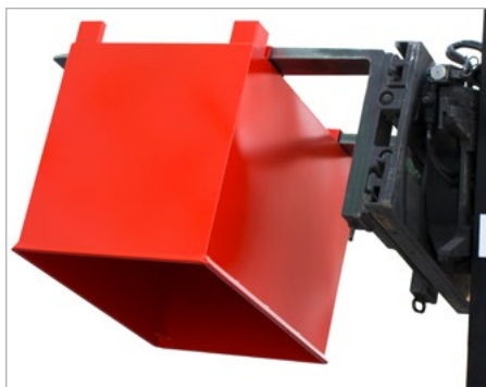
Entleerung durch Stapler mit Drehgerät
