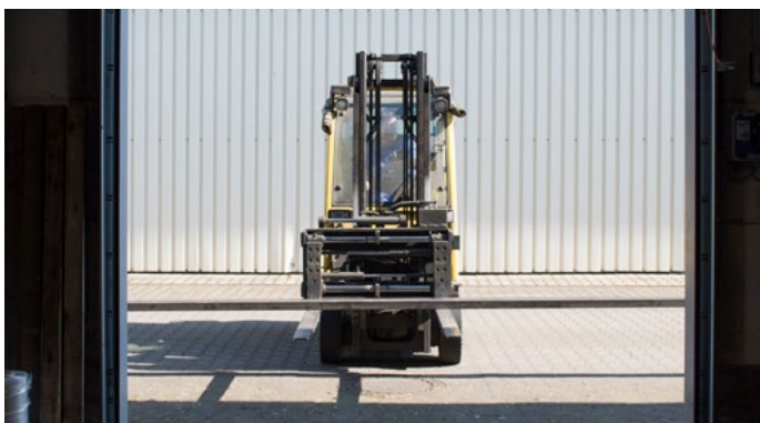
Transport von Langgutmaterial durch Tore ohne LSL nicht möglich
