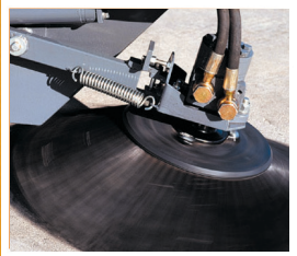
Hydraulisch angesteuerte Hauptkehrwalze und Seitenbesen
