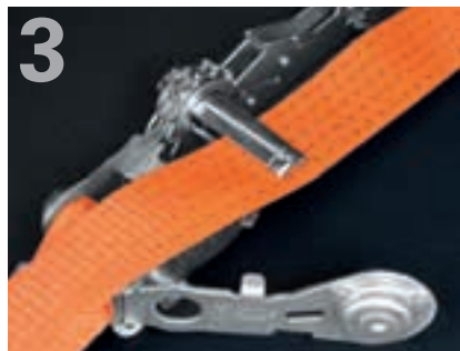
3 Gurtband einlegen Das Gurtband lässt sich einfach in den offen liegenden Schlitz der Halbwelle einlegen.
