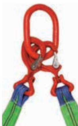
KBR-Haken (bis 2.000 kg) mit Hebeband im Ovalglied
