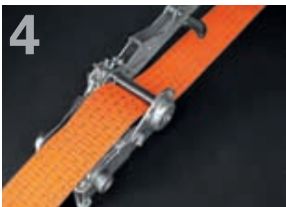
4 Seitenteil schließen Nachdem das Gurtband eingelegt ist, muss das Seitenteil wieder geschlossen werden.
